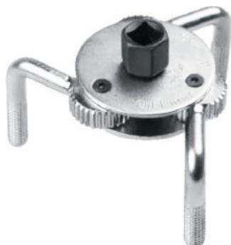
· O saca filtro é uma chave com uma função bem específica: extrair o filtro automotivo. Ela nunca deve ser usada na instalação do mesmo, pois o aperto com a mão já é suficiente, caso contrário, será muito difícil retirar o filtro depois.
